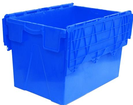
Caja con tapa de plástico de alquiler con unas dimensiones de 600x400x400mm. Equipada con una tapa abatible. Encajable y apilable. Tiene una base y paredes laterales cerradas y una capacidad de 70l. Fabricado con PP Virgen. Peso propio de 2,6kg.
