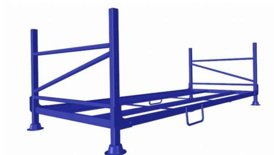
Estantería de neumáticos de alquiler con dimensiones de 2343x1078x787mm. Los soportes de neumáticos están recubiertos con pintura en polvo RAL 5010. Plegables y apilables. La capacidad de carga de este bastidor es de 300 kg (28 neumáticos).
