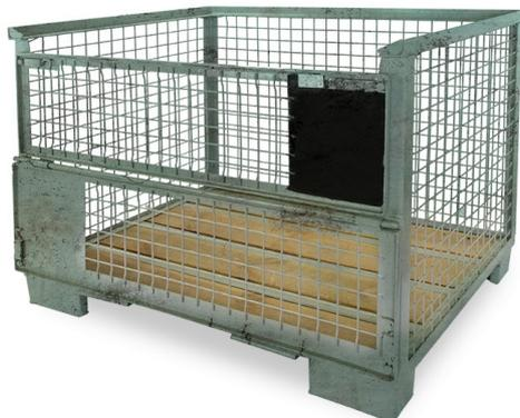
GIBO de metal DIN para alquiler con dimensiones de 1240x835x970 mm. El peso propio es de 85 kg. La capacidad de carga estática es de 4000kg. El gitterbox está equipado con dos puertas plegables en el lado largo, Cumple con las normas EPAL.
